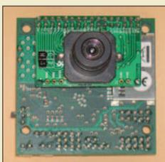
Intelligenten Steuerungen in Form von Robotern fehlte bisher eine einfache Möglichkeit, Objekte optisch zu verfolgen. Dies ist nun mit der CMUCam3 möglich, die sich obendrein auch noch programmieren lässt.
