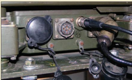
Aus NATO-Beständen sind zurzeit die FM-Transceiver SEM-25 und SEM-35 auf dem Surplus-Markt erhältlich. Der Beitrag erörtert Vorzüge und Grenzen bezüglich des Einsatzes im Amateurfunk. Das Foto zeigt, wie die zahlreichen Buchsen am SEM-25 mit der Nummer des erforderlichen Kabels beschriftet sind.
