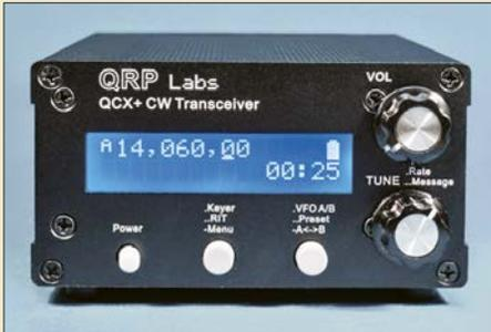
Mit dem QCX+ ist seit einiger Zeit der direkte Nachfolger des QCX bei QRP Labs erhältlich. Er eignet sich aufgrund der größeren Auslegung besser für den Selbstbau und bietet ausreichend Platz für Erweiterungen. Dieser Beitrag stellt den Transceiver vor und liefert einige grundlegende Informationen zu Montage und Inbetriebnahme. Foto: DC8FG
