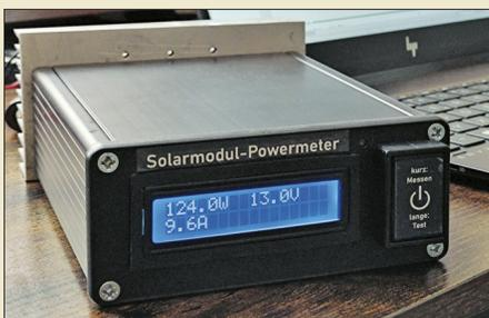
Die messtechnische Überprüfung der Leistungsfähigkeit von PV-Modulen bzw. Solarpanelen ist zuweilen sinnvoll und wünschenswert. Das beschriebene Testgerät wurde zu diesem Zweck entwickelt. Es benötigt keine eigene Spannungsversorgung und arbeitet weitgehend automatisch.
