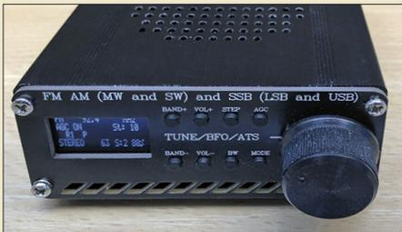
Der Schaltkreis Si4735 wurde seinerzeit für den Bau von AM/FM-Rundfunkempfängern entwickelt. Einige Händler aus Fernost haben ein auf diesem IC basierendes Radio im Liefersortiment. Dessen Funktionen und Eigenschaften sind Gegenstand dieses Beitrags, der am Schluss auch noch einige Hinweise für den Selbstbau bereithält. Foto: DO7LJ 708
