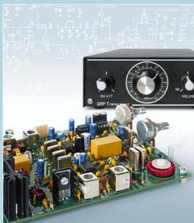
Wer sich im Bausatzsektor umsieht, der findet überwiegend Transceiver für Telegrafie. Von QRP Ham Radio Kits in Spanien ist jedoch mit dem ILER-20v3 ein SSB-QRP-Gerät für 20 m verfügbar, das sich schon hinsichtlich der relativ einfachen Technik gut für den Selbstbau eignet. Außerdem bietet es noch Platz für die eine oder andere Erweiterung. Ab S. 541 werden die Funktion beschrieben und Aufbauhinweise gegeben.
