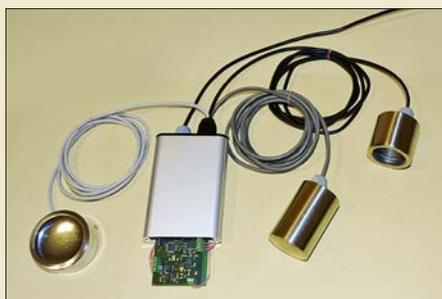
Die Übertragung von Datensignalen im Wasser ist für viele Anwendungen wichtig, ebenso die Ortung von Objekten. Gegenüber elektromagnetischen Wellen im LF-Bereich bietet Ultraschall in solchen Fällen eine Reihe von Vorteilen. Auf diese Weise lassen sich z. B. Daten an Taucher übertragen oder die Kommunikation zwischen zwei Punkten mit dem Wasser eines Flusses als Übertragungsmedium realisieren.
