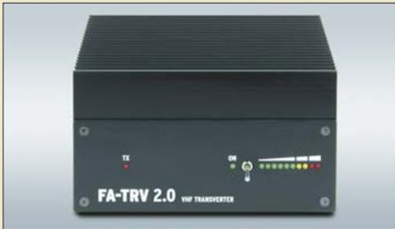
Wer die vielfältigen technischen Möglichkeiten der modernen KW-SDR-Transceiver von Icom oder Yaesu auch auf dem 2-m-Band nutzen möchte, kann z. B. auf den Transverterbausatz FA-TRV zurückgreifen. Die in der Betriebspraxis mit dem Icom IC-7300 und IC-7610 gewonnenen Erkenntnisse führten zu einigen Modifikationsvorschlägen am Transverter.
