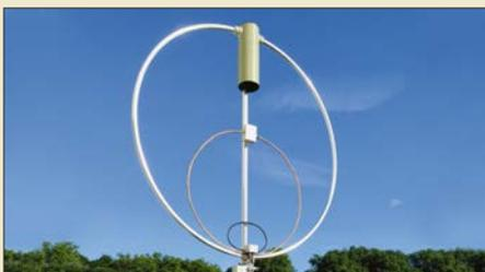
Die konstruktive Ausführung einer Magnetantenne gibt die obere Abstimmgrenze vor. Diese ist daher im Nachhinein kaum noch beeinflussbar. Mit einer kleinen Zusatzschleife ist es jedoch möglich, ohne größeren Aufwand ein weiteres Band zu erschließen, wie an einer kommerziellen Loop-Antenne gezeigt wird.
