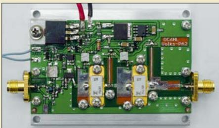
Eigenbaustationen für den Satellitenfunkbetrieb über QO-100 nutzen zum Teil Komponenten wie den Adalm Pluto, die auf der Sendeseite im 13-cm-Band nur sehr wenig Ausgangsleistung liefern. Eine passende Lösung bietet die hier vorgestellte, kompakte Linearendstufe.
