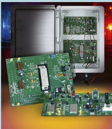
Kleine, leichte und energiesparende FM-Handfunkgeräte sind für den Notfunkbetrieb im Nahbereich gut geeignet. Eine transportable, einfach zu installierende FM-Relais-funkstation mit autarker Stromversorgung kann helfen, mit solchen Geräten auch über größere Entfernungen stabile Verbindungen herzustellen.
