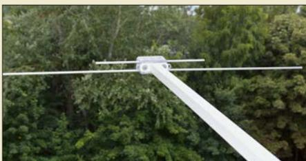
Für Funkamateure mit beschränkten Antennenmöglichkeiten wurde eine Duoband-Antenne für 2 m und 70 cm konstruiert, welche am Fenster oder am Balkon montiert, Zugang zur Ortsrunde und zu umliegenden Relais bietet. Dieses Selbstbauprojekt hat sich in mehreren Exemplaren über Jahre bewährt. Foto: DG0KW
