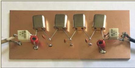
Dem Seitenbandrauschen des Sendeteils eines Transceivers wird in Testberichten kaum Beachtung geschenkt. Es entsteht, weil die sendeseitigen Verstärkerstufen dem Phasentrauschen des VFOs weiteres AM-Rauschen hinzufügen. Im Beitrag wird ein Messverfahren vorgestellt und erörtert, wann dieses Rauschen stört. Foto: DC4KU
