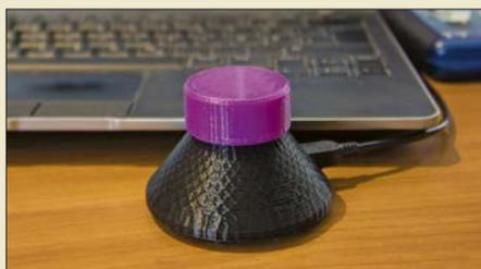
Die Bedienung von SDR-Software erfolgt üblicherweise mittels PC-Maus und Tastatur. Eine zusätzliche Möglichkeit, häufig genutzte Funktionen aufzurufen, bietet die hier vorgestellte Drehkopfsteuerung auf Basis des Arduino Nano und des aus dem Musikbereich stammenden MIDI-Protokolls.
