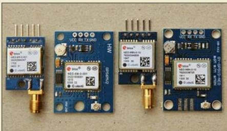
GPS-Empfänger geben neben Positions- und Zeitdaten exemplarabhängig auch eine Impulsfolge ab. Die Module von U-Blox sind mit und ohne GPS-Signal als frei programmierbare Oszillatoren von 1 Hz bis 24 MHz nutzbar. Im Beitrag wird die Einstellung des Taktausgangs beschrieben. Foto: DJ5AM
