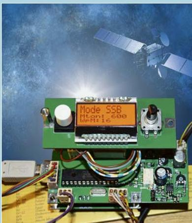
Computergestützten SDR-Eigenbauprojekten fehlt zumeist die Anschlussmöglichkeit für ein konventionelles Standmikrofon und eine Morsetaste. Das im Beitrag auf Seite 715 beschriebene Selbstbauprojekt bietet für dieses Problem eine praxiserprobte Lösung.
