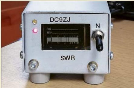
Ein Gerät zum Messen des Stehwellenverhältnisses nutzt wohl jeder Funkamateur sowohl im heimischen Shack als auch bei Portabelaktivitäten. Im Beitrag werden Hinweise zum Aufbau eines SWV-Meters aus Fertigmodulen gegeben, das mit wenig Bedienelementen auskommt und das schnelle Erfassen der Messwerte ermöglicht. Foto: DC9ZJ
