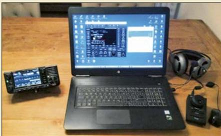
Der IC-705 von Icom hat bereits alles an Bord, was für die Fernsteuerung des QRP-Transceivers über WLAN nötig ist. Hier wird in Form einer Schritt-für-Schritt-Anleitung beschrieben, wie man das Gerät ins Netzwerk einbindet und die Software RS-BA1 für den Fernsteuerbetrieb konfiguriert. Screenshot: DC4KU 1020
