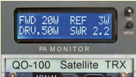
In ihrer Sende-Empfangs-Station für QO-100 verwenden viele Funkamateure das 20-W-Endstufenmodul des bulgarischen Herstellers SG Laboratory Ltd. Die hier vorgestellte Zusatzbaugruppe bietet eine Leistungs- und SWV-Anzeige. Sie ist leicht modifizierbar und daher auch für andere Endstufenprojekte geeignet. Foto: DC5ZM 1008
