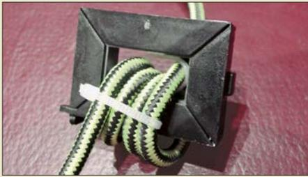
Die Integration eines Computers eröffnet im Funkbetrieb vielfältige Möglichkeiten, ist aber gleichzeitig auch Einfallstor für hochfrequente Energie. Der Beitrag beschreibt, wie sich mit einfachen Mitteln HF-Einstrahlungen reduzieren lassen. Foto: DJ6JZ 990
