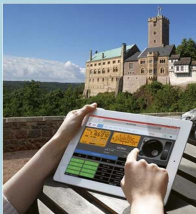
Der Stationsserver MFJ-1234 ist ein Kleinstcomputer mit Peripherie zur Steuerung eines – auch älteren – Stationstransceivers. Er erlaubt den Funkbetrieb in Fonie, Digimodes und CW sowohl direkt im Shack, im heimischen (W)LAN als auch entfernt über das Internet. Am fernsteuernden Computer/Smartphone/Tablet ist lediglich ein Webbrowser nötig.
