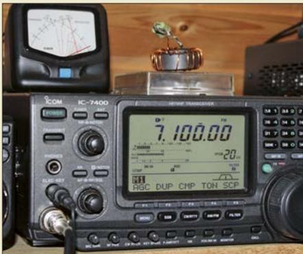
In jüngster Zeit sind endgespeiste Drahtantennen mit einem Un-Un-Übertrager 1:9 sehr populär. Besser als Antennen mit Zufallslängen sind dabei solche mit resonanten Längen. Das minimiert Verluste und schafft klare Resonanz- und Impedanzverhältnisse. Im Bild ist ein Testaufbau mit FT140-43 und Abschlusswiderständen zu sehen, der kurzfristig mit 30 W Sendeleistung aus einem IC-7400 belastet wird. Das Messinstrument zeigt bei 7,1 MHz fast keinen Rücklauf. Foto: DK7ZB 430
