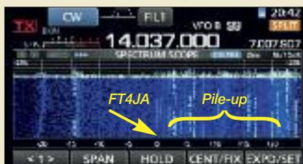
Wie gelingt eine Verbindung mit einer begehrten DX-Station, wenn man nicht der einzige Anrufer ist? Ein solches „haufenweises“ Aufeinandertreffen von Anrufern nennt sich Pile-up. Im Bild (Display eines Icom IC-7300) sind CW-Stationen, die FT4JA im April 2016 anriefen, auf über 10 kHz verteilt.
