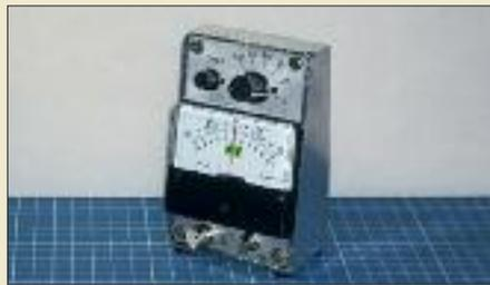
Das im Beitrag vorgestellte kompakte Gerät ist aufgrund seines mit  $1\text{ G}\Omega$  sehr hohen Eingangswiderstands für nahezu belastungsfreie Messungen von Gleichspannungen an hochohmigen Schaltungen geeignet. Darüber hinaus kann es zur Demonstration einiger interessanter physikalischer Effekte dienen.
