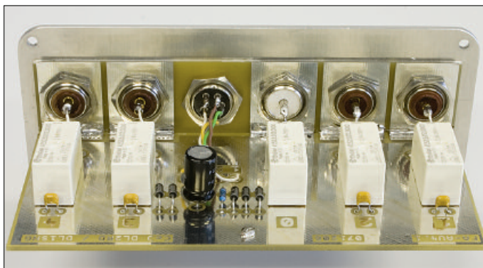
Bild 1: Der Kontaktstreifen der Platine wird rechtwinklig mit dem Hauptteil der Platine verlötet und dient gleichzeitig zu deren Befestigung am Bodenwinkel des Mastgehäuses.
