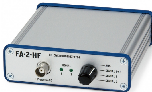
Bild 1: HF-Zweitongenerator von FUNKAMATEUR
