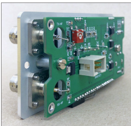
Bild 18: Die Leiterplatte ist beidseitig mit SMD-Bauteilen bestückt.
