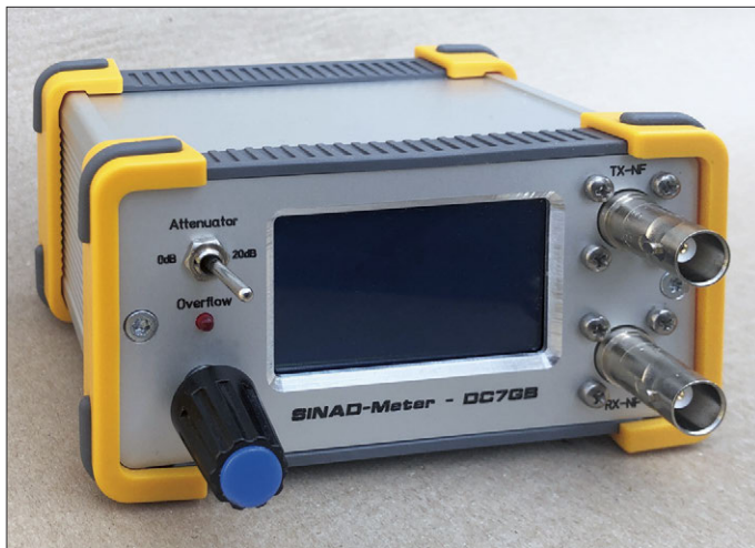
Bild 1: Ansicht des SINAD-Messgeräts Foto, Screenshot: DC7GB
