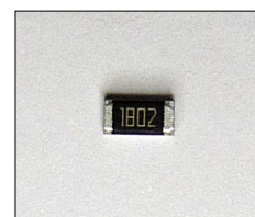
Bild 3: Widerstand mit aufgedrucktem Code; die Ziffernfolge 1802 bedeutet 18 kΩ
