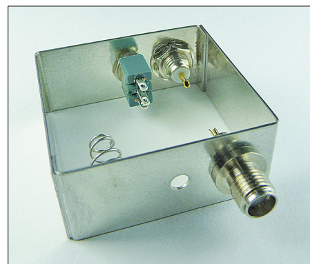
Bild 18: Verlötete Gehäuseseitenteile mit eingebauten SMA-Buchsen und montiertem Kippschalter (Einbaulage beachten!)
