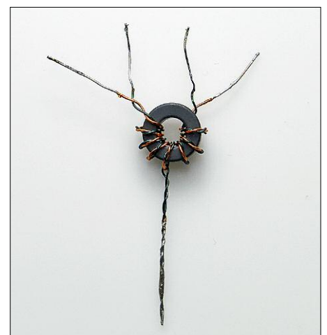
Bild 10: Fertig gewickelter Übertrager Ü2 mit verzinnenden Anschlüssen
