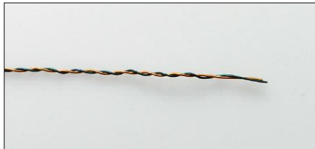
Bild 3: Vorbereiteter Wicklungsdraht für Ü1
