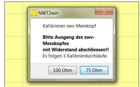
Bild 10: Vor dem Start der automatischen Kalibrierdurchläufe muss man den Wert des verwendeten Referenzwiderstands angeben.
