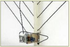
Empfangsantennen bekannt. Im Beitrag wird eine von SMOVPO entwickelte Variante aufgebaut, gemessen und getestet. Ist ein spannungsfester Drehkondensator vorhanden, lässt sich diese Antenne einfacher als eine herkömmliche Magnetantenne mit Einwindungsschleife aufbauen. Sie bewährt sich als angenehm ruhige Empfangsantenne und eignet sich mit Abstrichen auch zum Senden auf 80 m. Foto: Red. FA
