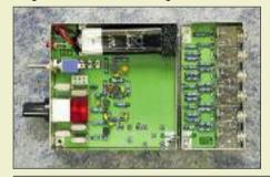
Ein quarzgesteuerter HF-Generator mit definiertem Ausgangspegel kann bei der Überprüfung von Empfängern und der S-Meter-Kalibrierung eine große Hilfe sein. Im Beitrag von DJ8IL wird ein für den KW-Bereich entwickelter, abgleichfreier Testgenerator vorgestellt, der demnächst
