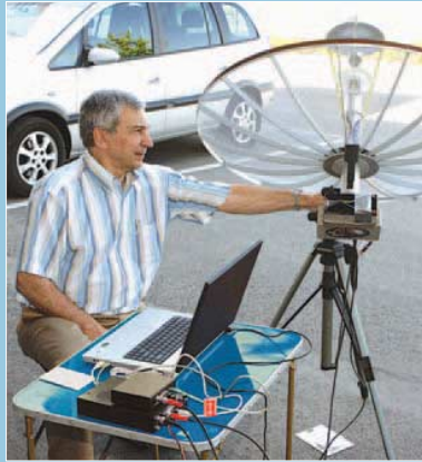
Ob auf der Erde oder im Weltraum, Funkamateure überwinden Grenzen und suchen Herausforderungen: Freddy de Guchteneire, ON6UG, zeigte auf der Ham Radio 2008 den Empfang der 80 Mio. km von der Erde entfernten Raumsonde STEREO-A mit einem 1 m „kleinen“ Parabolspiegel. Foto: DL1ABJ
