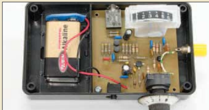
Hochfrequente Empfangsstörungen sind heutzutage leider allgegenwärtig. Ihre Quellen ggf. aufzuspüren hilft dieser Suchempfänger, der dank Platine und Spezialteilen aus dem FA-Leserservice schnell nachzubauen ist.
