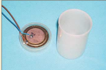
Alle Objekte im Wasser, die Schall abgeben, lassen sich mit einem einfachen, selbst gebauten Unterwasser-mikrofon aufspüren. Setzt man zwei dieser Hydrofone ein, ist durch den Stereoeffekt sogar eine Richtungsbestimmung möglich.
