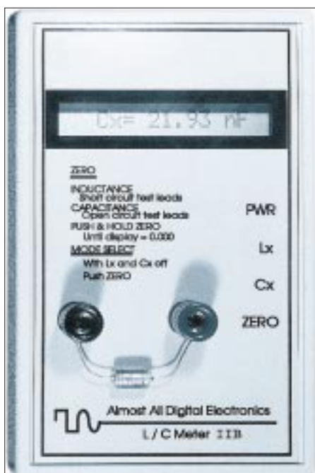
Bild 2: Das L/C-Meter II B von Almost All Digital Electronics in der Gesamtansicht.
